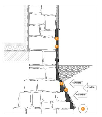
Ainsi le transport de l'humidité stockée est interrompu, empêchant ainsi la pénétration d'une nouvelle humidité. Ensuite on peut commencer avec l'application de l'enduit d'assainissement.
