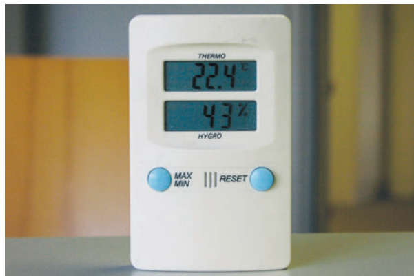
Bild 10: Thermo- und Hygrometer zur Messung von Temperatur und relativer Luftfeuchtigkeit.
