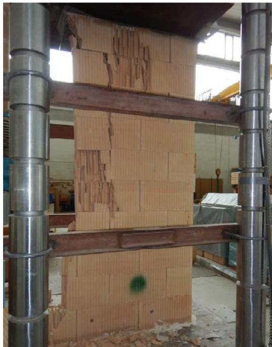
Bruchbild der Mauerwerksprüfung p+f expert AG
